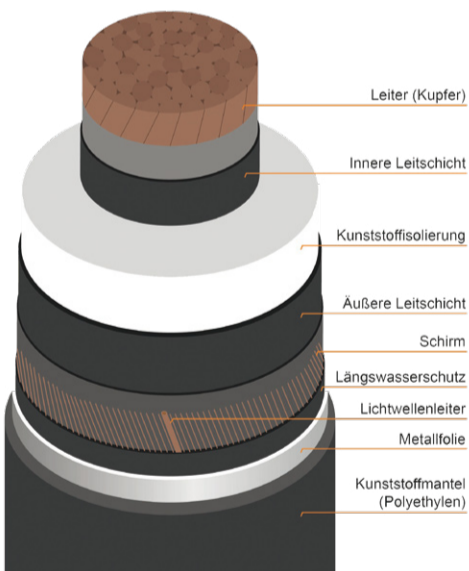
Schematischer Aufbau eines Erdkabels.
