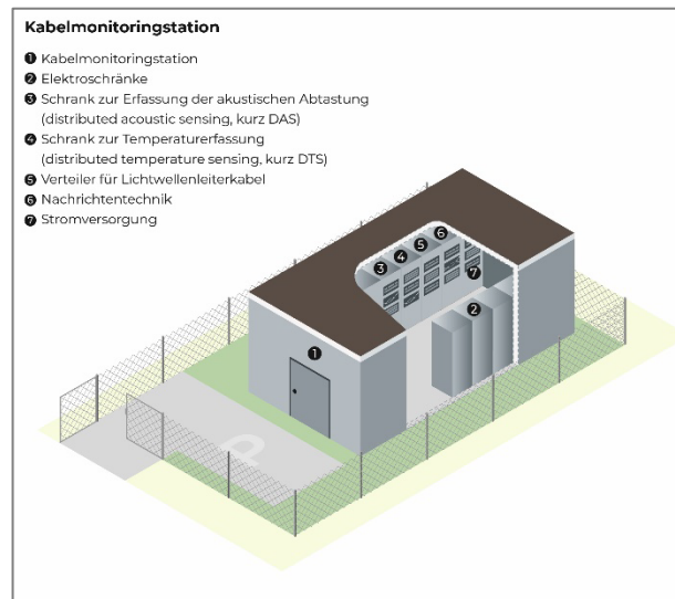
Schematische Darstellung einer Kabelmonitoringstation für 2 Gigawatt
